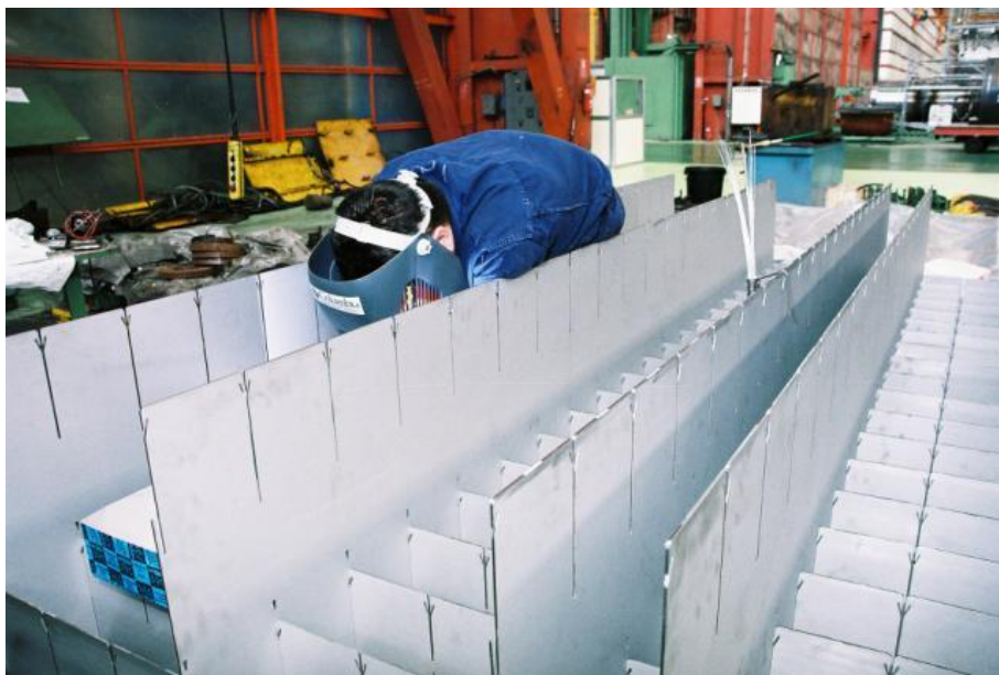
Fabricación de un “rack” para piscina de combustible quemado. Chapas de acero inoxidable.
