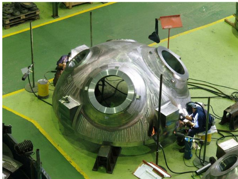
Fondo de generador de vapor constituido por una sola forja.
