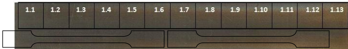
Figura 5. Extracción de las probetas SPT y de las probetas de tracción a partir de la tira 1 (la más próxima a la línea de fusión).
