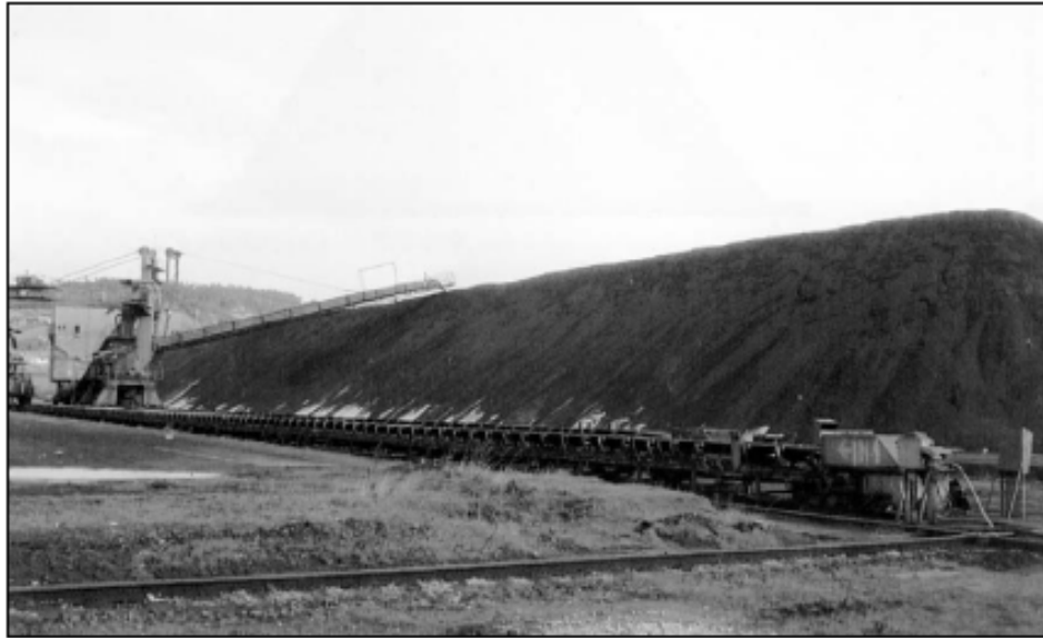
Formación de la parva de homogeneización
