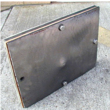
Figura 3: Blindaje NANOBAIN después de un ensayo de balística
