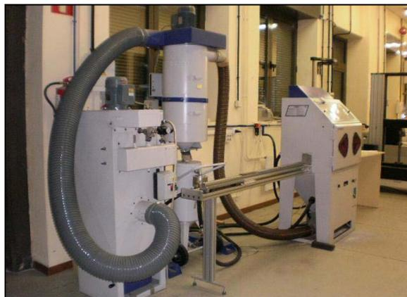
Fig. 1. Máquina de shot peening de presión directa
