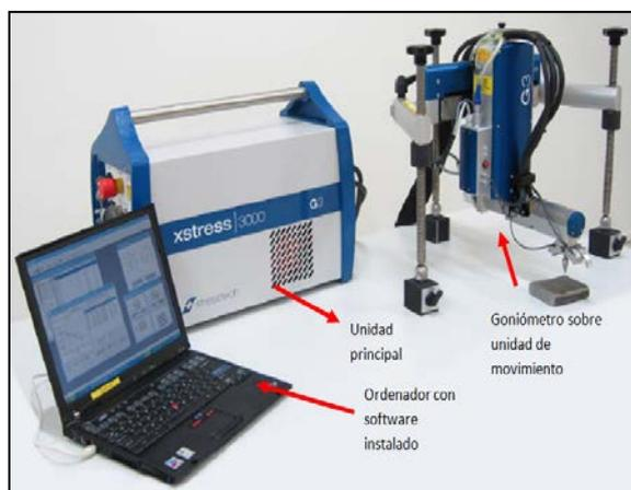
Fig. 2. Difractómetro de rayos X (STRESSTECH 3000 G3)
