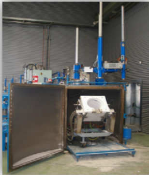
Horno de fusión empleado que permite la fusión y colada en vacío o en atmósfera controlada.
